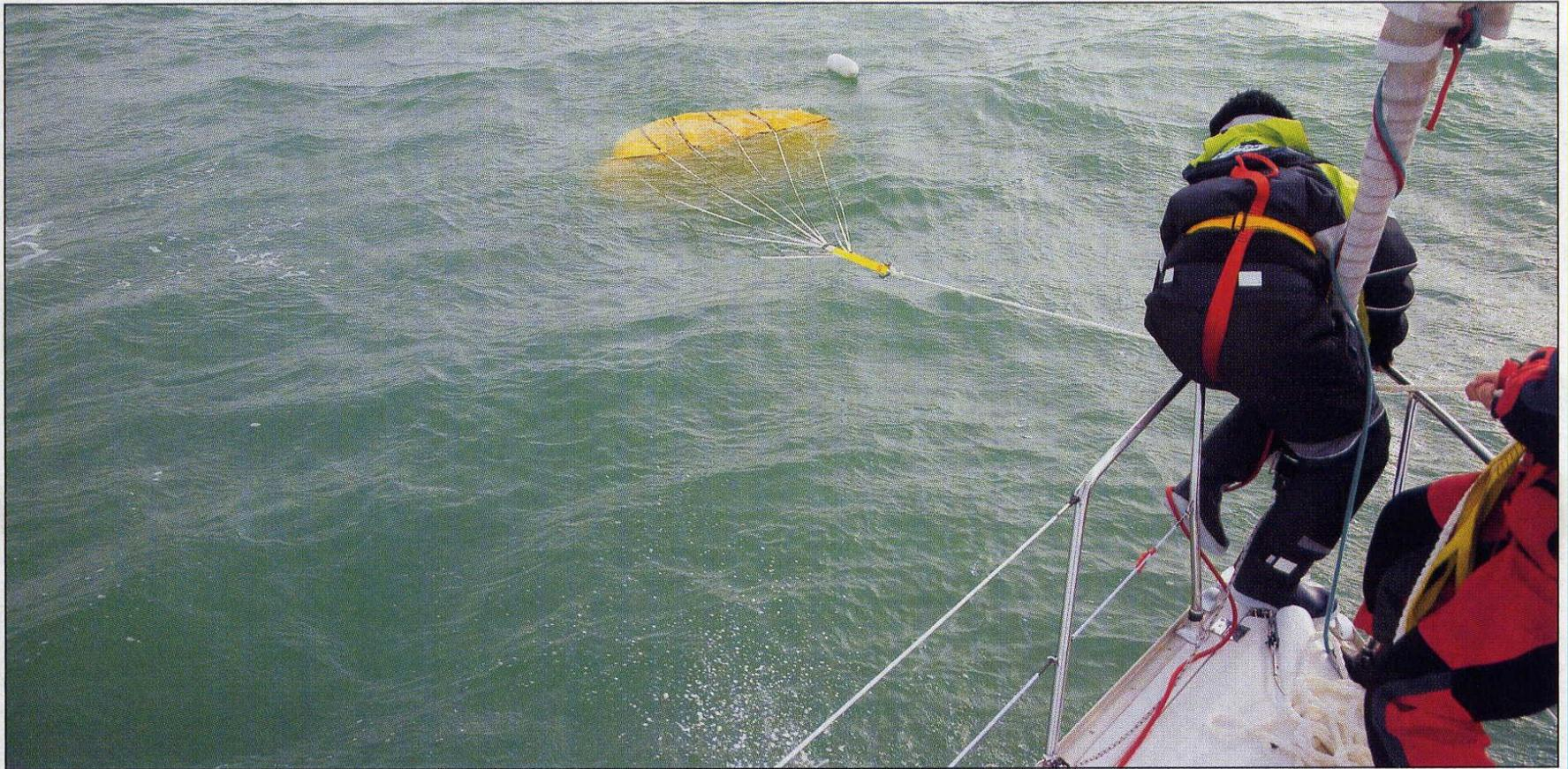
**Ancre parachute. Attention au ragage ! Le câblot de l'ancre parachute, dont le fonctionnement ressemble à celui d'une ancre classique, a tendance à raguer sur les ferrures d'étrave. A protéger avec soin.**
