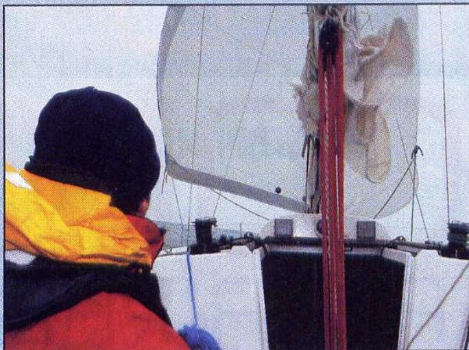
*Avec les deux voiles d'avant en ciseaux et la grand-voile affalée, plus aucun risque de partir au lof ou à l'abattée. Ni de voir la bôme balayer le cockpit dans un empannage involontaire.*
